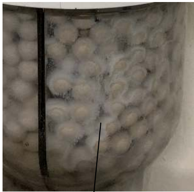
Figure 5 - Précipité de sel déposé sur le média neutralisant des échangeurs de chaleur en aluminium
