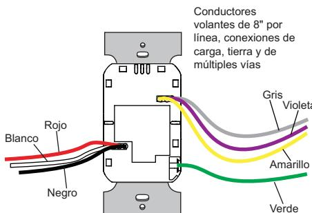
**Advertencia:** Conectar a tierra los cables Violeta y Gris puede dañar la unidad. No aplique potencia al sensor hasta que TODOS los cables estén conectados o tapados si el controlador va a instalarse en el futuro.
