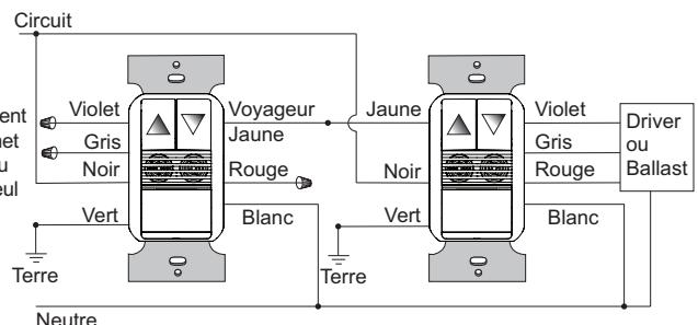
**Avertissement:** La mise à la terre des fils Violet et Gris peut endommager l'unité. N'appliquez pas d'alimentation au détecteur tant que TOUS les fils ne sont pas connectés ou obturés si le driver doit être installé ultérieurement.
