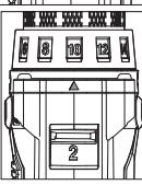
S'il est réglé adéquatement, l'embrayage glisse au couple approprié et évite à l'utilisateur d'enfoncer excessivement les vis dans différents matériaux et d'endommager les vis ou l'outil.
