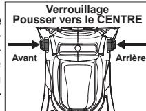
2. Pour une rotation en **marche arrière** (dans le sens anti-horaire), pousser le commutateur sur le côté gauche de l'outil. **Vérifier la direction de rotation avant utilisation.**
