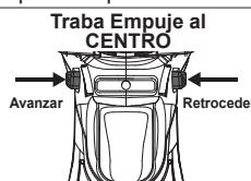
2. Para **retroceder** (el giro es en el sentido opuesto a las manecillas del reloj), se presiona el interruptor de control colocado al lado izquierdo del taladro. **Verificar la dirección del giro antes de usarlo.**
