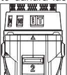
3. Para usar el modo destornillador, rote el torque selector hasta que el símbolo aparezca alineado con la flecha. El embrague ajustable, cuando está bien ajustado, patinará al par de torsión preestablecido para impedir que el tornillo entre demasiado en diferentes materiales y para impedir dañar el tornillo o la herramienta.
