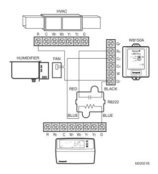
Fig. 10. Wiring fan for a steam humidifier.
